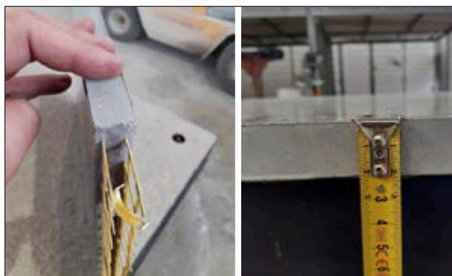
7. ábra: 2 cm vastag textilbeton elemek
