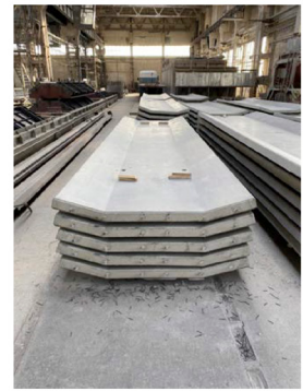
4. ábra: Közúti vasbeton terelőelemek és árokelemek
