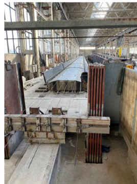
4. ábra: Közúti vasbeton terelőelemek és árokelemek
