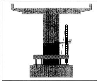
Fig. 2 Automatic wrapping (fib. 2000)
